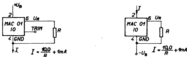
Obr. 29. Zdroj proudu pro záporné výstupní napětí
